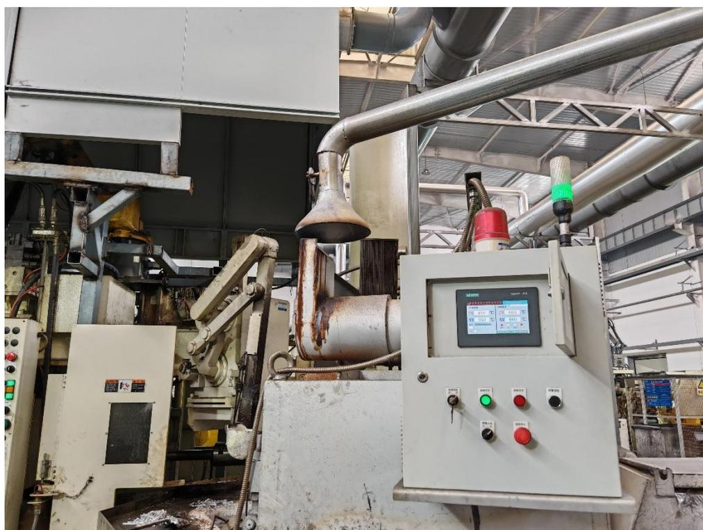
图4.1-2 保温炉废气收集照片
