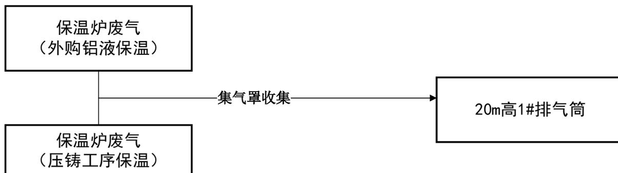
图4.1-1 保温炉废气处理工艺流程图
