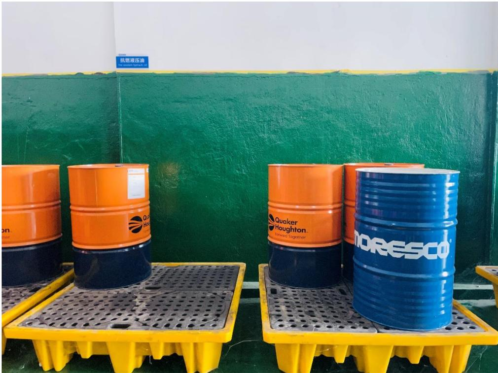
图 4.1-14 项目液体原料采用托盘贮存照片
